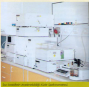
Sıvı örneklerin incelenilebildiği Kütle Spektrometresi.
