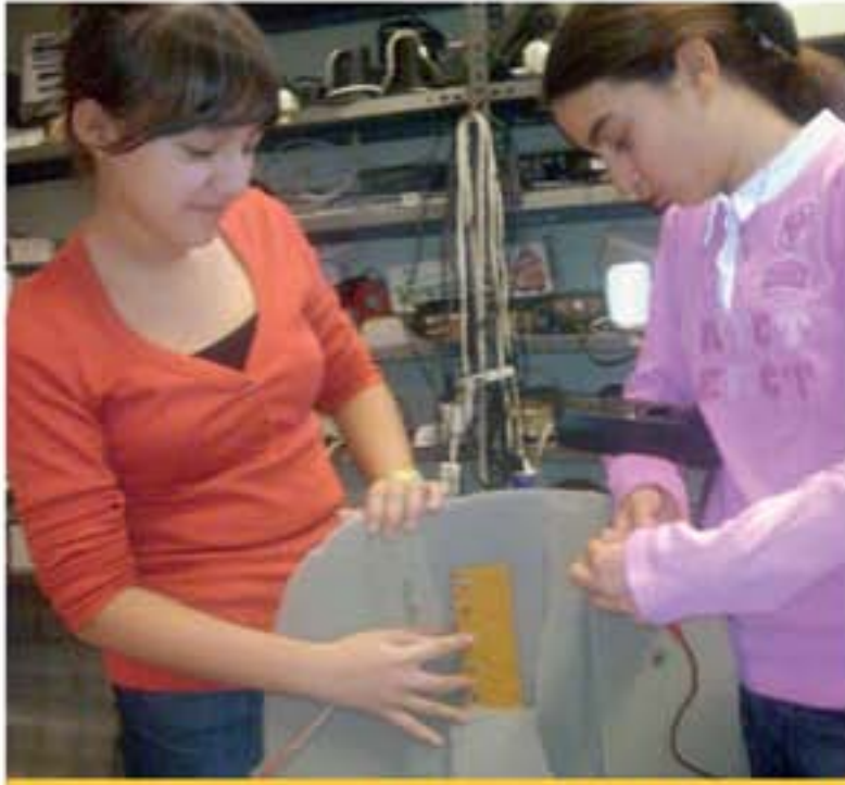
Basınca duyarlı sensörlerin koltuğa monte edilmesi
