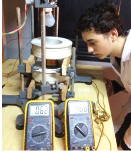
Akım voltaj değerlerinin okunması ve manyetik alanın hesaplanması
